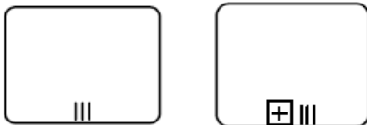
Фигура 10.48 – Задача и Подпроцесс с Многоэкземплярным маркером для параллельного выполнения
