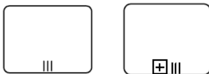
Фигура 10.49 – Задача и Подпроцесс с Многоэкземплярным маркером для последовательного выполнения
