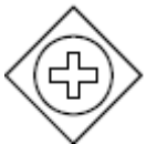
Фигура 10.119 – Параллельный, основанный на Событиях Шлюз, используемый для запуска экземпляра Процесса.
