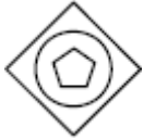
Фигура 10.118 – Эксклюзивный, основанный на Событиях Шлюз, используемый для запуска экземпляра Процесса.
